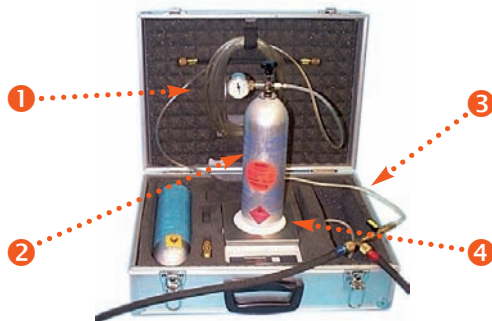
Зураг 11. Нүүрстөрөгчийн (НС) цэнэглэх байгууламж
