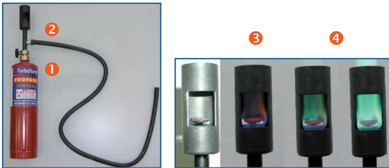
Зураг 3. Галоид нэгдлийг хөргөх шингэн алдагдлыг тодорхойлох багаж (Европын Холбоод хэрэглэхийг хориглосон)
