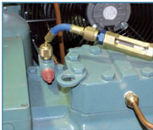
Зураг 15. Компрессорын сорох шугамын тос шалгаж байна.
