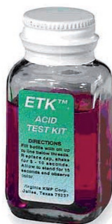
Зураг 17. POE полиэфирийн тосны чанар шалгах тест.
