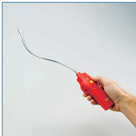
Зураг 21. Электрон алдагдал илрүүлэгчээр алдагдал шалгаж байна.
