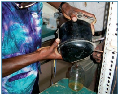
Зураг 17. Битүү компрессороос тосны дээж авч байна.
