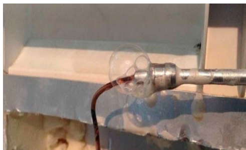
Зураг 5. Төрөл бүрийн холболт дээрх алдагдлыг хөөсөөр илрүүлж буй нь
