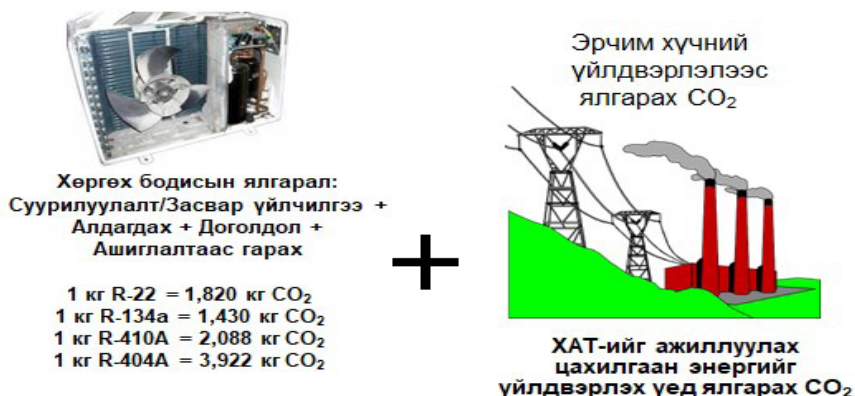
Зураг 7. Хөргөлт, агааржуулалтын (эйркондиционер) тоног төхөөрөмжийн дэлхийн дулааралд үзүүлж буй нөлөө [3]
